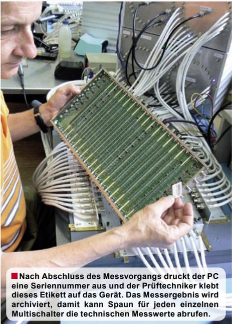
■ Nach Abschluss des Messvorgangs druckt der PC eine Seriennummer aus und der Prüftechniker klebt dieses Etikett auf das Gerät. Das Messergebnis wird archiviert, damit kann Spaun für jeden einzelnen Multischalter die technischen Messwerte abrufen.
