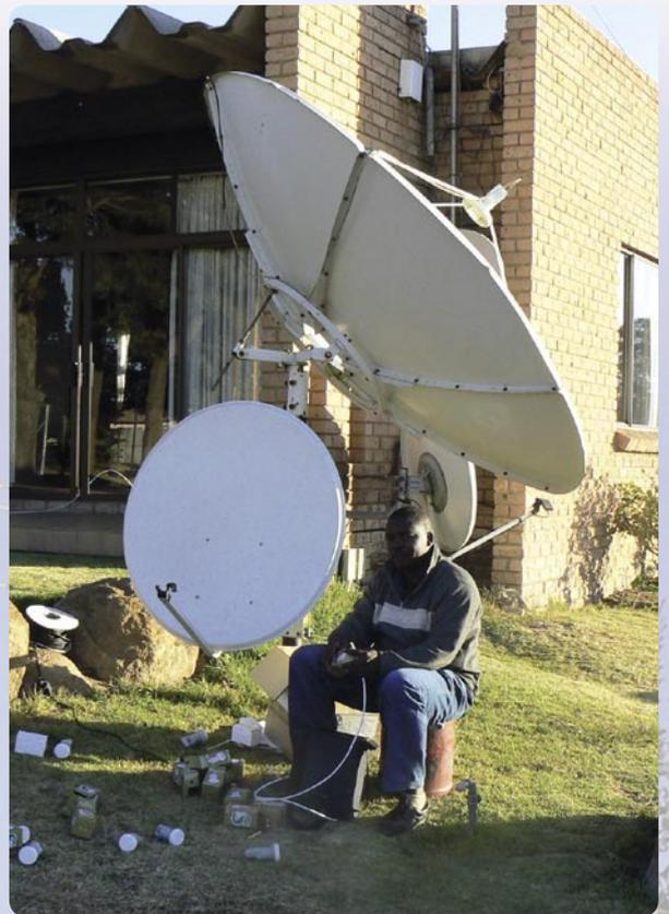
Funktionstest einer neuen LNB-Lieferung: einer der Mitarbeiter testet jeden LNB auf Funktionstüchtigkeit: der LNB wird an ein Meßgerät angeschlossen, und an den auf 68.5 ausgerichteten Spiegel gehängt.
