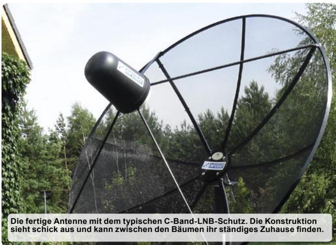
Die fertige Antenne mit dem typischen C-Band-LNB-Schutz. Die Konstruktion sieht schick aus und kann zwischen den Bäumen ihr ständiges Zuhause finden.
