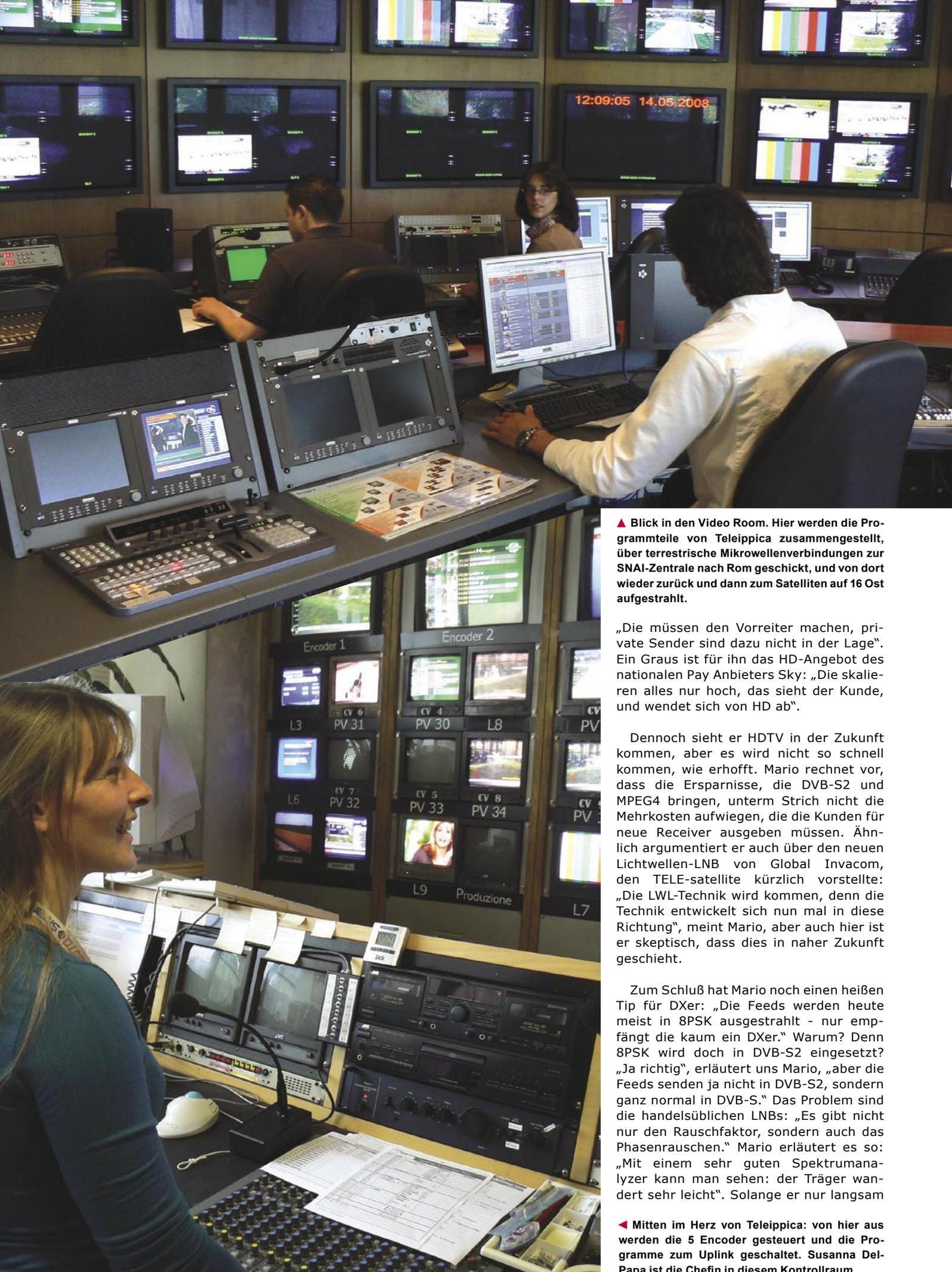
▲ Blick in den Video Room. Hier werden die Programmteile von Teleippica zusammengestellt, über terrestrische Mikrowellenverbindungen zur SNAI-Zentrale nach Rom geschickt, und von dort wieder zurück und dann zum Satelliten auf 16 Ost aufgestrahlt.
