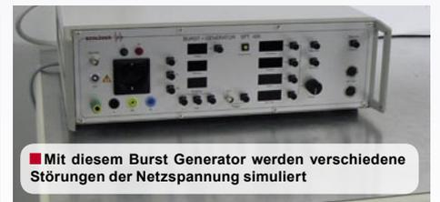
■ Mit diesem Burst Generator werden verschiedene Störungen der Netzspannung simuliert
