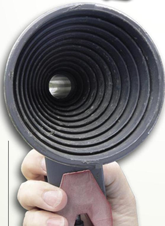
Noch ist die LNB-Dreheinrichtung nicht fertig, aber so ist die Funktion: der Motor mit Zahnrad wird an das Feed montiert, der LNB wird mit einem Zahnradring und dem Flansch drehbar im Feed montiert. Schon kann Ron den LNB fernbedient von horizontal nach vertikal drehen.
