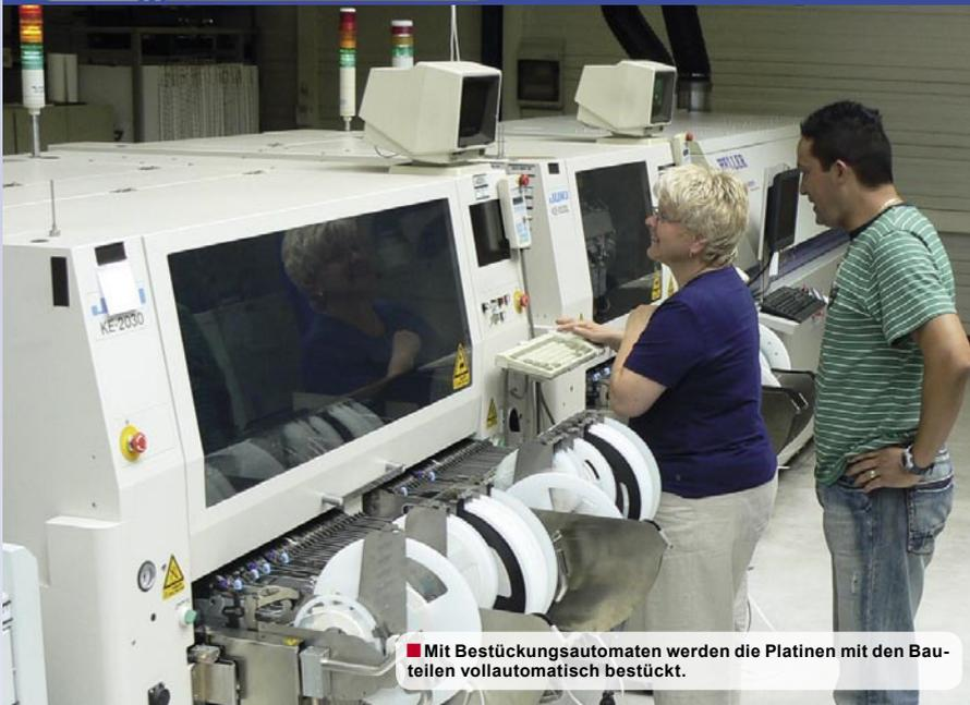
■ Mit Bestückungsautomaten werden die Platinen mit den Bauteilen vollautomatisch bestückt.
