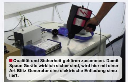
■ Qualität und Sicherheit gehören zusammen. Damit Spaun Geräte wirklich sicher sind, wird hier mit einer Art Blitz-Generator eine elektrische Entladung simuliert.
