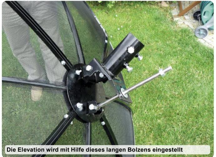
Die Elevation wird mit Hilfe dieses langen Bolzens eingestellt
