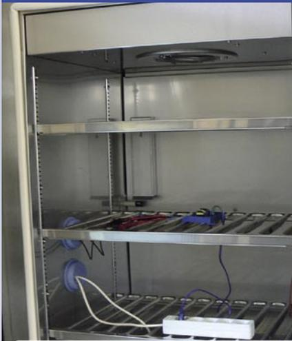
■ Stichprobenweise werden fertige Multischalter auch in dieser Klimakammer getestet. „In unseren Spezifikationen geben wir an, dass unsere Geräte für Temperaturen von -20° C bis +50° C geeignet sind“, erläutert Friedrich Spaun und fährt fort: „Aber wir testen natürlich von -30° C bis +60° C, um wirklich sicher zu sein.“
