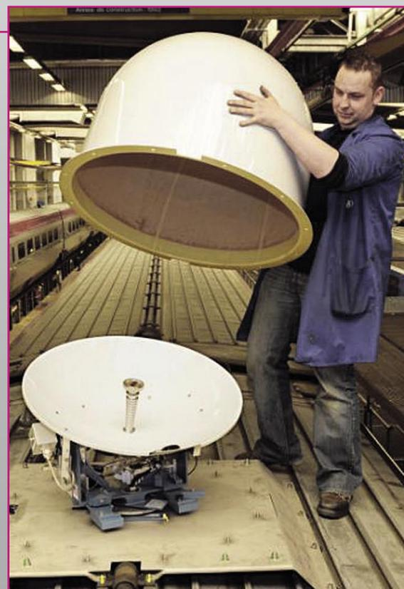
Fertig! Der Radom wird auf die Antenne aufgesetzt, und das System ist nicht nur wettergeschützt, sondern auch gegen die enorme Windlast bei 300 km/h geschützt.
