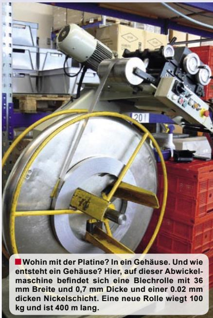
■ Wohin mit der Platine? In ein Gehäuse. Und wie entsteht ein Gehäuse? Hier, auf dieser Abwickelmaschine befindet sich eine Blechrolle mit 36 mm Breite und 0,7 mm Dicke und einer 0,02 mm dicken Nickelschicht. Eine neue Rolle wiegt 100 kg und ist 400 m lang.
