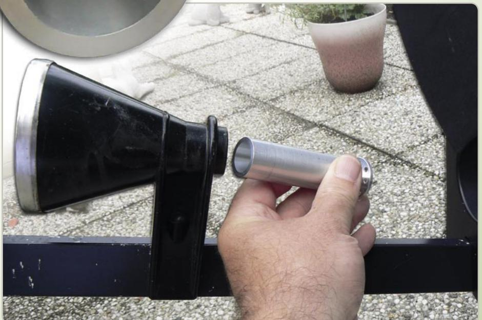
Das Feed ist exakt an die vorhandene Reflektorantenne angepaßt und wird in das vorhandene Trichterfeed eingesteckt.
