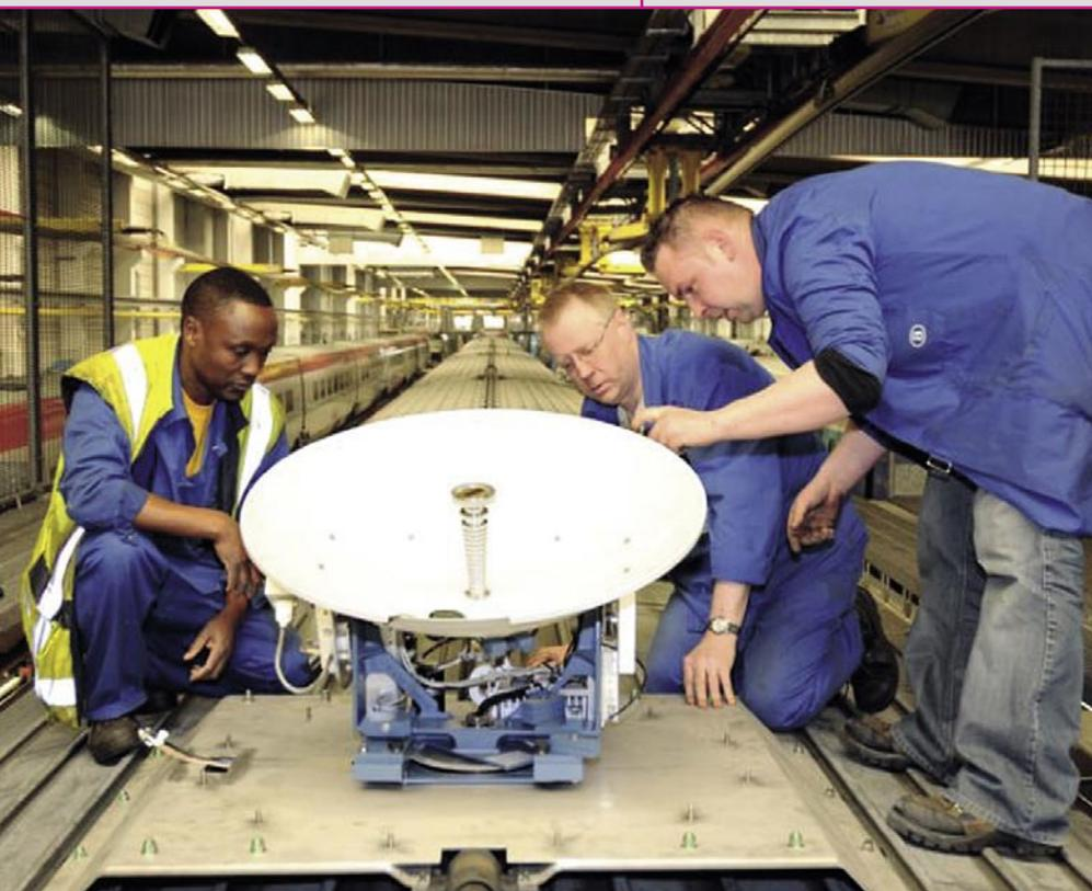
Techniker von 21net montieren die von SeaTel gelieferte Satellitenantenne für den mobilen Empfang des HISPASAT. Da der Thalys Hochgeschwindigkeitszug keine großen Steigungen fährt, konnte die Antenne auf einen relativ kleinen Elevationsspielraum optimiert werden. So kann die Windlast etwas geringer gehalten werden durch einen etwas niedrigeren Radom.
