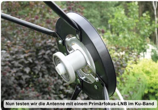
Nun testen wir die Antenne mit einem Primärfokus-LNB im Ku-Band
