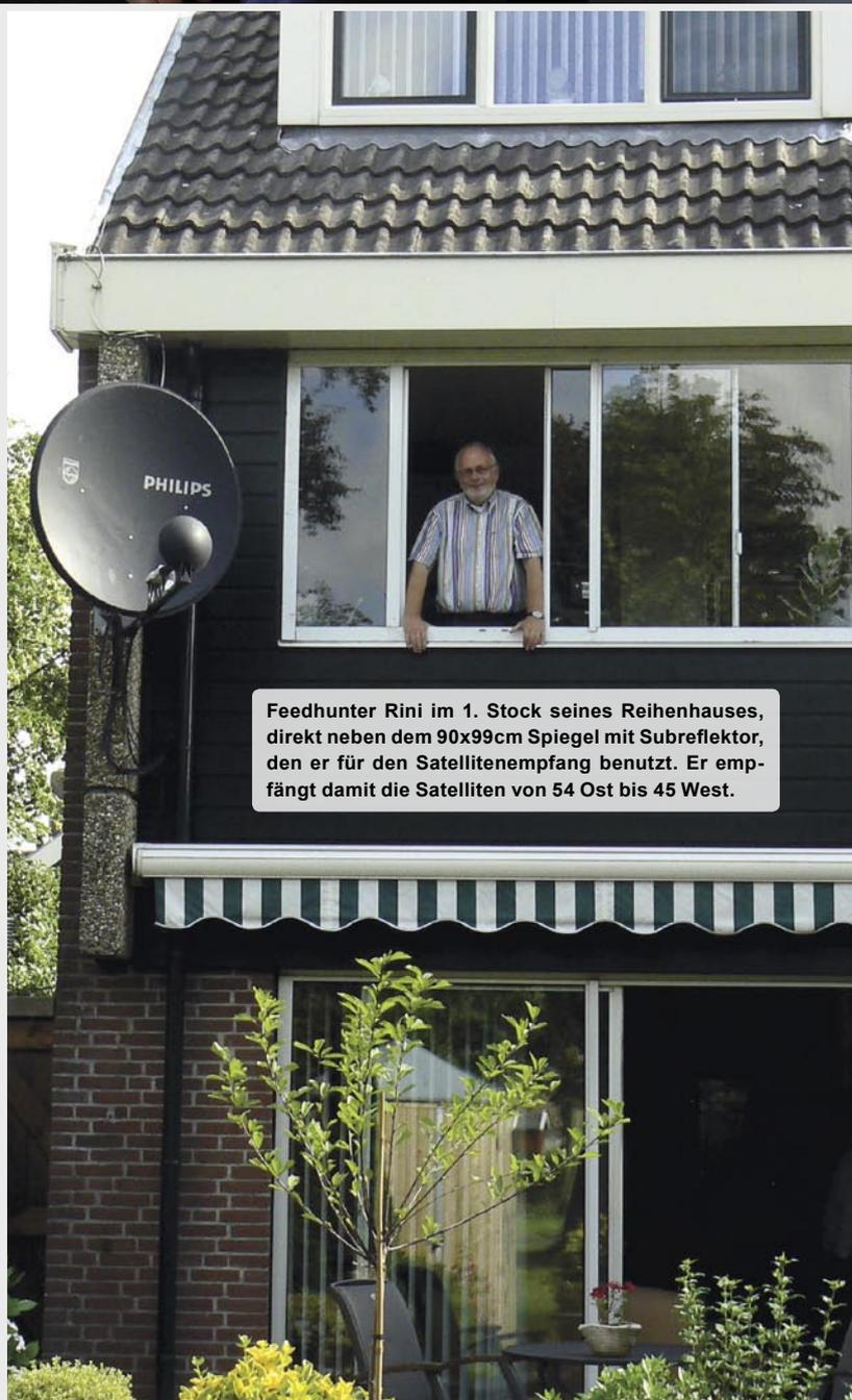
Feedhunter Rini im 1. Stock seines Reihenhauses, direkt neben dem 90x99cm Spiegel mit Subreflektor, den er für den Satellitenempfang benutzt. Er empfängt damit die Satelliten von 54 Ost bis 45 West.
