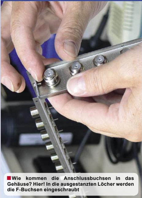
■ Wie kommen die Anschlussbuchsen in das Gehäuse? Hier! In die ausgenutzten Löcher werden die F-Buchsen eingeschraubt
