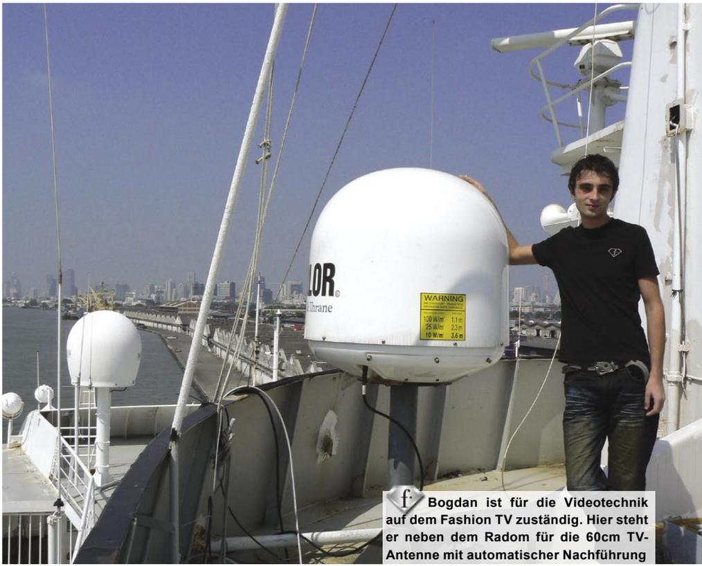
**f** Bogdan ist für die Videotechnik auf dem Fashion TV zuständig. Hier steht er neben dem Radom für die 60cm TV-Antenne mit automatischer Nachführung
