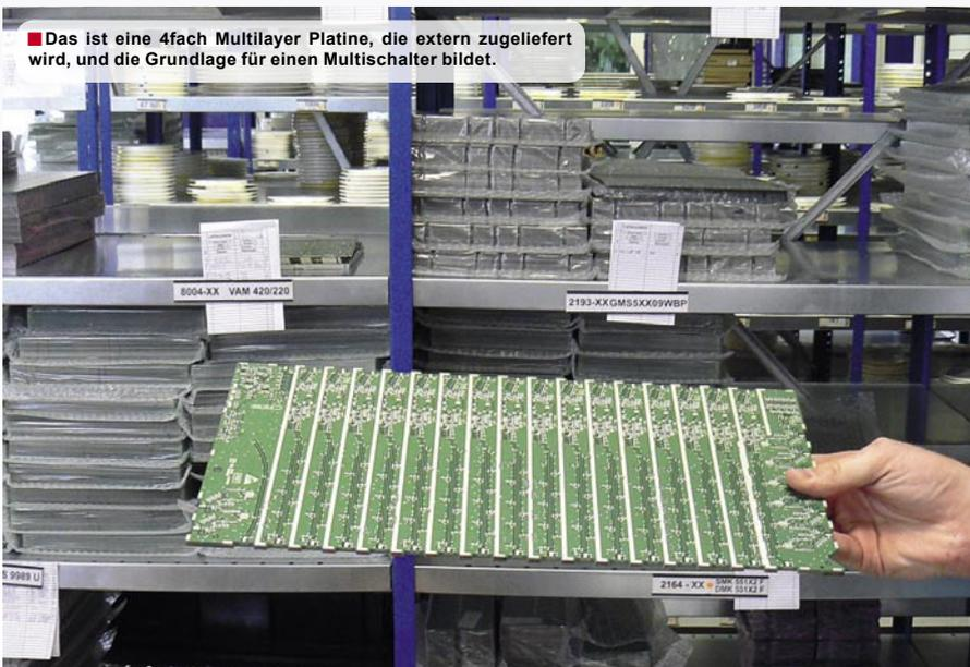
■ Das ist eine 4fach Multilayer Platine, die extern zugeliefert wird, und die Grundlage für einen Multischalter bildet.
