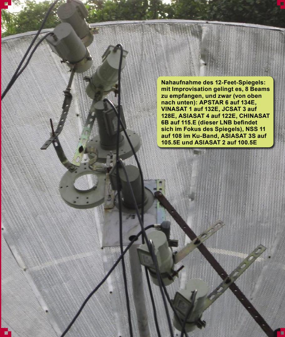
Nahaufnahme des 12-Feet-Spiegels: mit Improvisation gelingt es, 8 Beams zu empfangen, und zwar (von oben nach unten): APSTAR 6 auf 134E, VINASAT 1 auf 132E, JCSAT 3 auf 128E, ASIASAT 4 auf 122E, CHINASAT 6B auf 115.E (dieser LNB befindet sich im Fokus des Spiegels), NSS 11 auf 108 im Ku-Band, ASIASAT 3S auf 105.5E und ASIASAT 2 auf 100.5E
