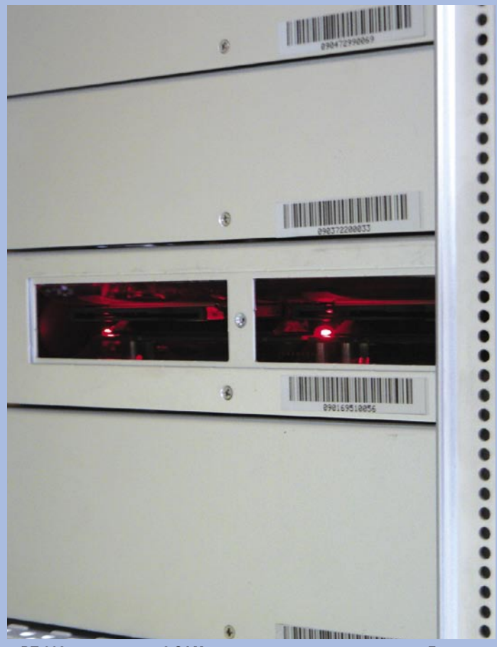
■ DT-302 модулът има 2 CAM модула за декодиране на канали. До тях може да се достигне от горната страна, след сваляне на капака. За тази цел, разбира се, трябва да поставите валидни смарт карти.
