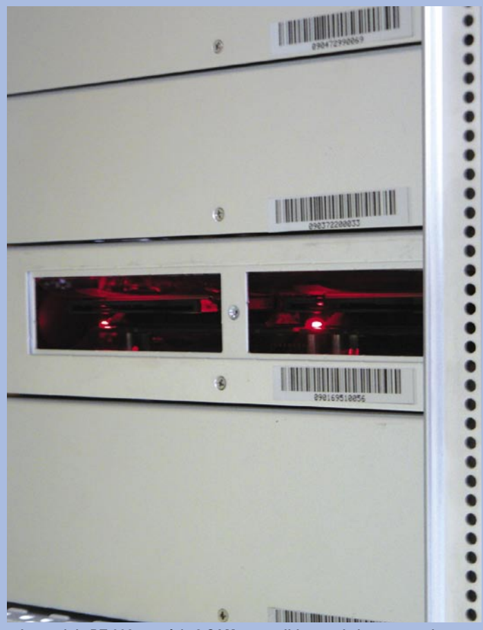
■ Le module DT-302 possède 2 CAM accessibles par le haut en soulevant un couvercle. Ils sont en mesure de décrypter les canaux brouillés. Bien sûr, vous devez introduire des cartes à puce valide.
