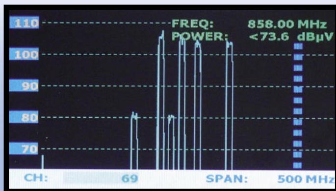
■ DTTV jedinica koja u ispitnoj konfiguraciji koja nam je bila na raspolaganju bila je u stanju generirati 6 DVB-T COFDM signala. Uz pretpostavku da svaki nositelj može prenijeti 8–10 SDTV kanala, jedna DTTV jedinica u stanju je isporučiti 48–60 digitalnih kanala!
