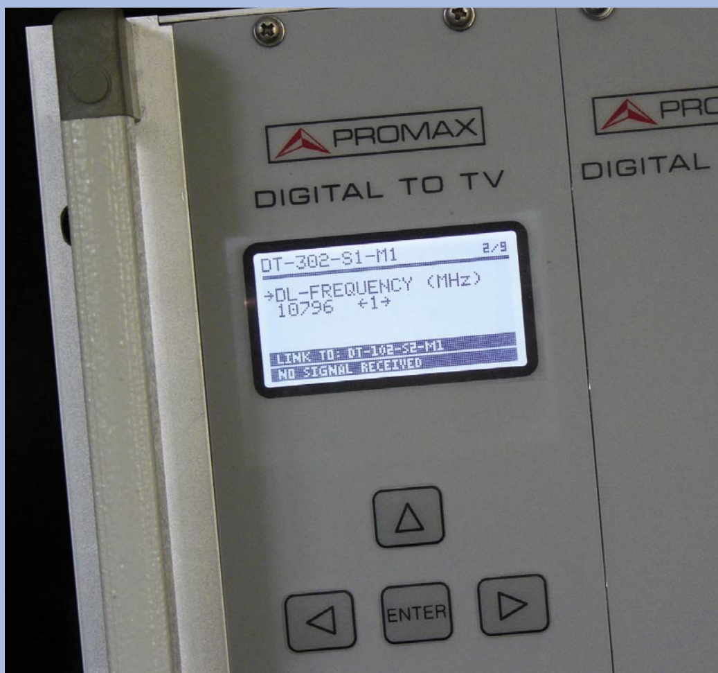
■ Podešavanje modula DT-302. Možete vidjeti podešavanje prijemne frekvencije transpondera koji će biti demoduliran u čist transportni stream.
