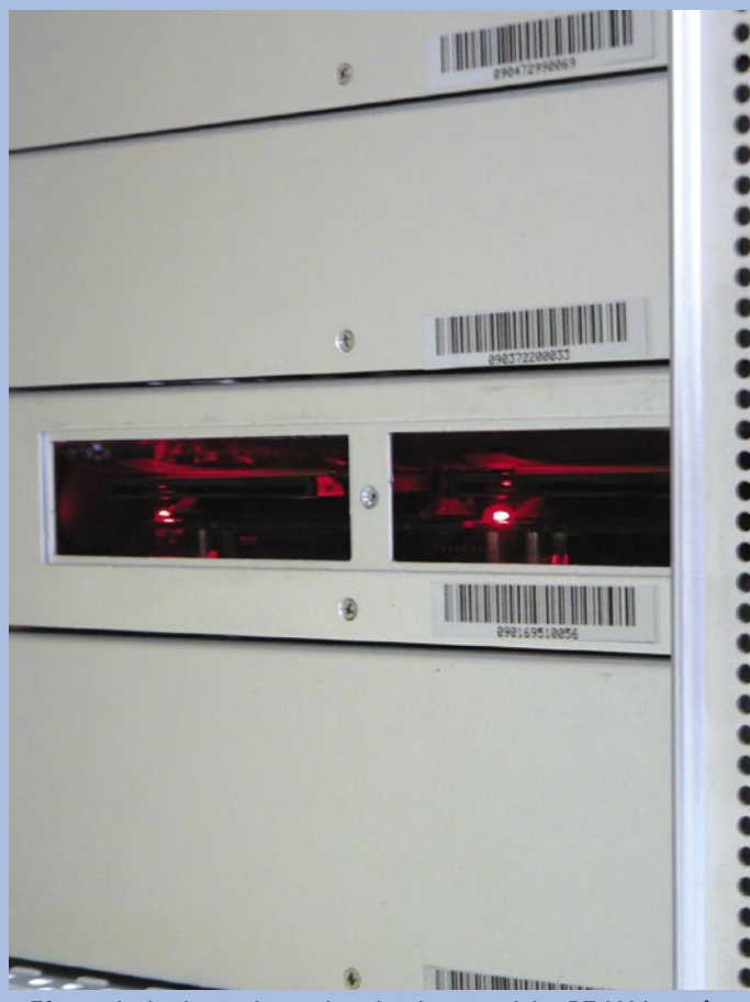
■ Efter att locket har tagits av visar det sig att modulen DT-302 har två stycken CAM som kan nås från toppen av modulen. Dessa CAMS används för att dekryptera krypterade signaler. Naturligtvis behöver du stoppa in giltiga programkort.
