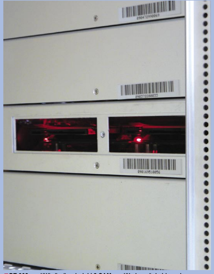
■ DT-302 modülünün üzerindeki 2 CAM modüle kapağı kaldırarak ulaşabiliyorsunuz. Bunlarla şifreli kanalları çözebilirsiniz. Tabii ki bunun için yayıncıdan alacağınız kartlara ihtiyacınız var.
