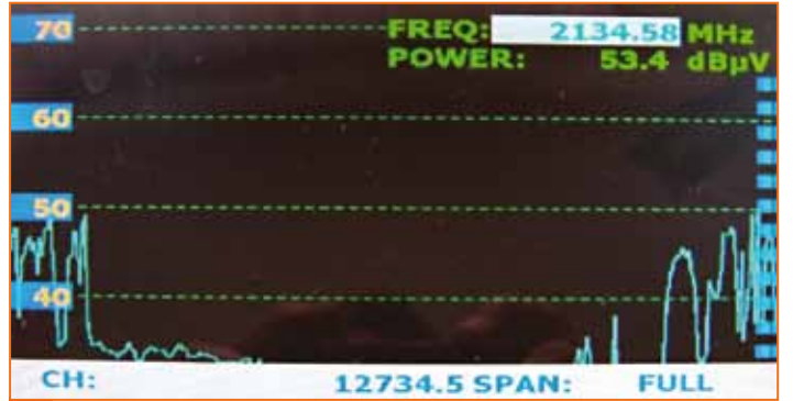
Koaksiyel LNB ile 22° Batı NSS7 spektrumu |
