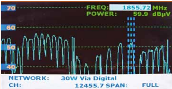
Koaksiyel LNB ile 30° Batı Hispasat spektrumu |
