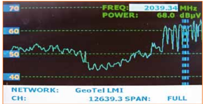
Invacom LNB ile 75° Doğu ABS1 spektrumu |
