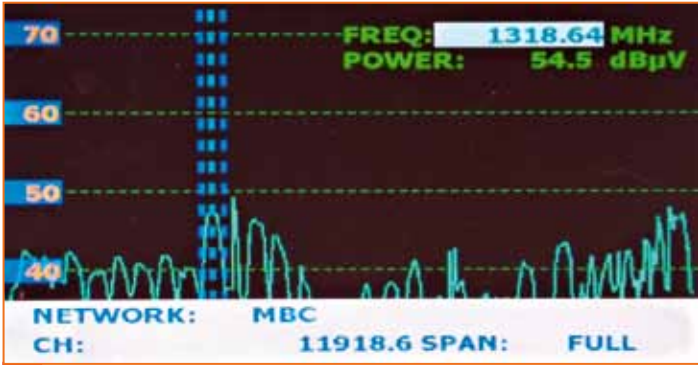
Koaksiyel LNB ile 26° Doğu BADR spektrumu |
