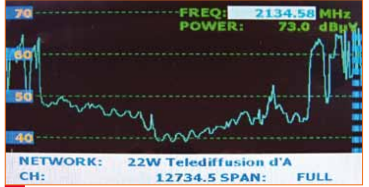
Invacom LNB ile 22° Batı NSS7 spektrumu |
