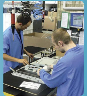
▲ يتم وضع اللوحة الإلكترونية الأم أعلى الشاشة و يتم تثبيتها بمسامير بعد وصول الشاشات المسطحة يتم تركيبها في الكابينة الخارجية لجهاز التلفزيون من الخلف : و هذه أول خطوة لإكمال تركيب الجهاز
