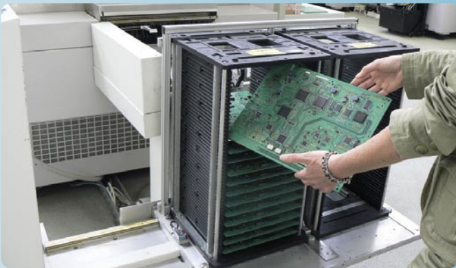
▲ لوحة إلكترونية كاملة جاهزة لإضافة مكونات كبيرة الحجم يدويا
