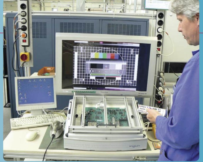
▲ السيد Frank Lehmann واحد من الفنيين يقوم بفحص اللوحة الإلكترونية الأم ، يتم توصيل اللوحة مع شاشة تلفزيون مسطحة للاختبار و يتم اختبار الوظائف عن طريق وحدة التحكم عن بعد
