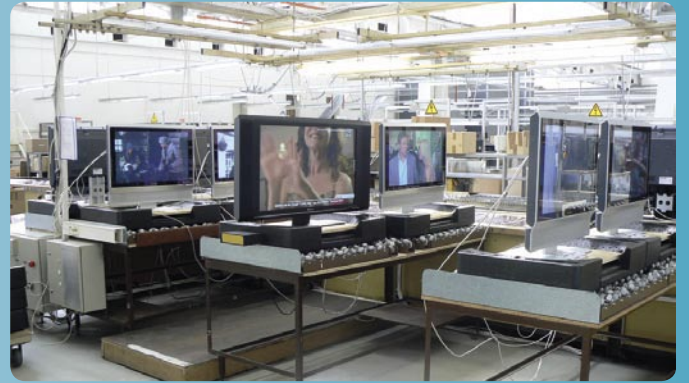
▲ بعد تركيب السماعات فإن التلفزيون المسطح جاهز للشحن / يتم أخذ عينات قليلة من خط الإنتاج و يتم إجراء اختبارات مطوله عليها .
