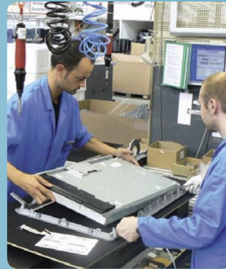
▲ يتم وضع اللوحة الإلكترونية الأم أعلى الشاشة و يتم تثبيتها بمسامير بعد وصول الشاشات المسطحة يتم تركيبها في الكابينة الخارجية لجهاز التلفزيون من الخلف : و هذه أول خطوة لإكمال تركيب الجهاز
