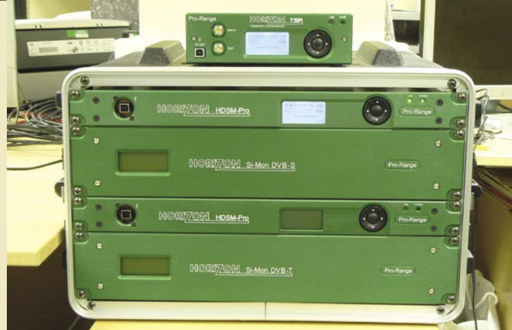
▲ سرى للغاية ! أول نموذج من وحدات القياس الاحترافية و التي تستخدم في شاحنات الإرسال OB لقياس جودة الإشارة ، و الوحدة في الأعلى لقراءة الموجات المرسله و هي أيضا معدة احترافية و سوف يتم تقديمها رسميا في الربع الثاني من عام 2008 .
