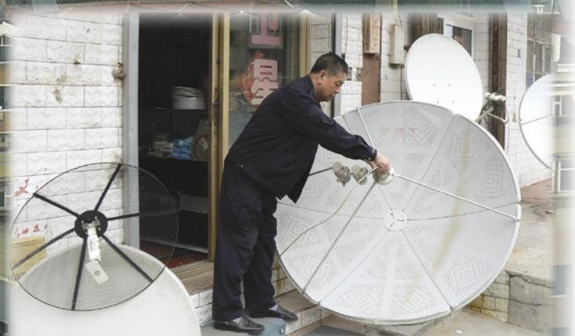
▲ السيد / Yin يمكن أن تراه هنا يقدم نظام استقبال مصنوع يدويا لاستقبال ثلاثة أقمار هما القمر SINOSAT 3 ( على اليسار ) و القمر CHINASTAR 6B ( في الوسط ) و القمر ASIASAT 3S ( على اليمين ) من بؤرة الطبق .
