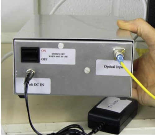
هذا ما يبدوا عليه اللوحة الحائطية : توضع الألياف الضوئية من الأمام مع موصلات قياسية للتوصيل مع الكابل المحوري لجهاز الريسيفر في الخلق و يمكنك أن ترى أن اللوحة الحائطية تحتاج طاقة من مدخل الإشارات لجهاز الريسيفر
