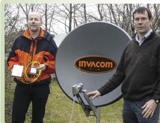
السويدي Norman Harris ( على اليسار ) و هو فني شركة Global Invacom و السيد Andrew Collar مدير المشروع يقومون بتركيب وحدة خفض الشوشرة الضوئية على طبق بقطر 90سم في مركز إجراء الاختبار التابع لمجلة تيلي ستلايت في فيينا بالنمسا .
