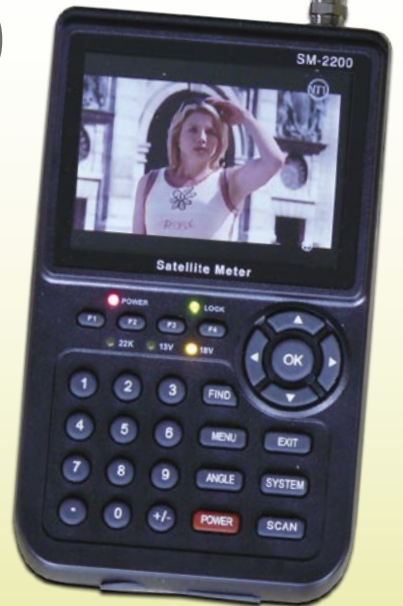
تستخدم وحدة قياس الإشارات Trimax SM-2200 كريسيفر محمول
