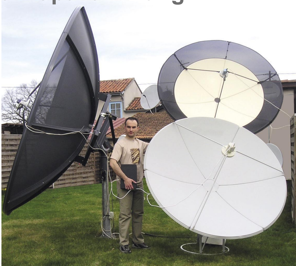
Sylvain Oscul sedang mengatur piringan 1,80m prime fokus. Dia dapat memeriksa ulang dengan piringan lainnya yang berukuran 2,40m dan 3,10m. |
