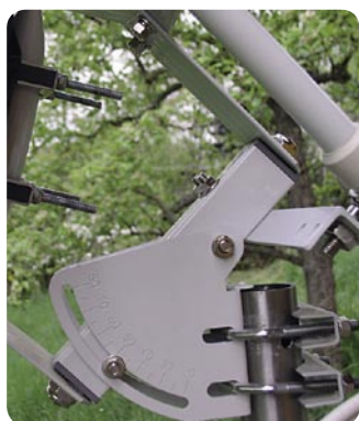
Skala Garis Lintang digunakan untuk mengatur parabola sesuai dengan letak geografis lokasi
