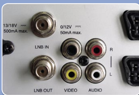
Colokan standar untuk LNB dan Audio
