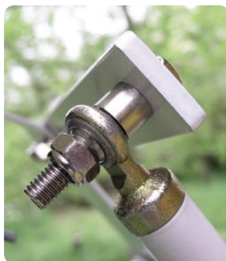
Ujung batang dirancang sebagai bearing jepit
