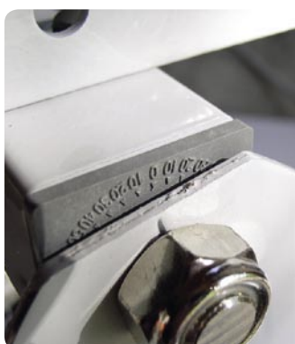
Skala sudut rotasi untuk menentukan posisi secara manual
