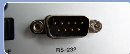
Dapat ditemukan pada kebanyakan receiver: colokan RS-232 untuk pemrograman melalui komputer
