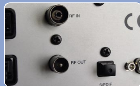
Konektor UHF (kiri) kini sudah jarang ada, sedangkan colokan S/PDIF mulai banyak digunakan
