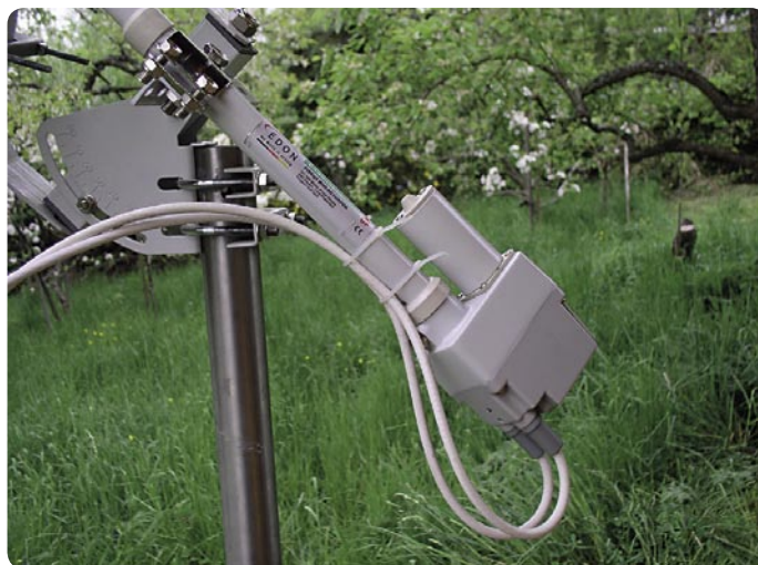
Motor menggerakkan penopang antenna
