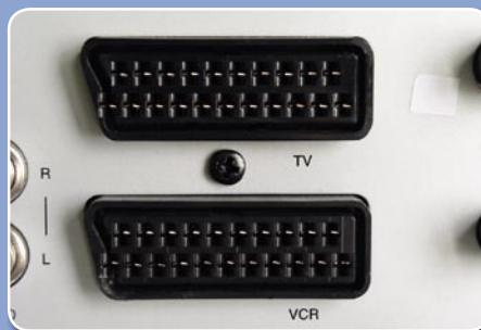
Umumnya pada receiver Eropa: dua colokan SCART untuk hubungan ke TV dan VCR
