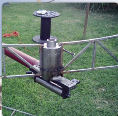
Bagian pusat antenna dengan 18 panel berjarak 20°
