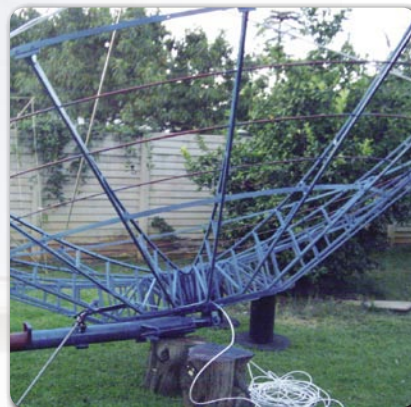
Seluruh lengan penopang sudah terpasang, selanjutnya pemasangan panel aluminium reflektor
