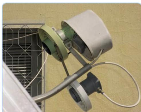
Satu solusi sederhana: satu batangan logam menghubungkan feed kedua terhadap feed fokus dengan polariser terintegrasi.
