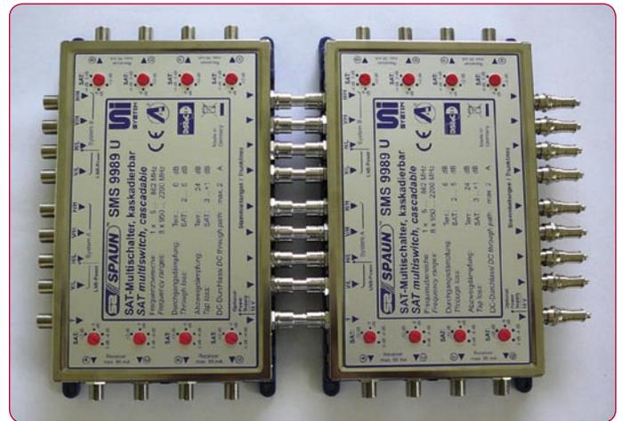
Satu unit SMS 9989 U dari SPAUN sudah memadai untuk menyalurkan ke 8 receiver, masing-masing mendapat akses ke sinyal dari dua LNB Quatro.
