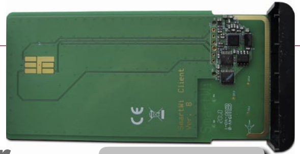
Tampak dekat antena tanpa penutupnya: konduktor berbentuk U di sebelah kanan yang menggunakan seluruh panjang kartu, pada versi 8 yang baru.
