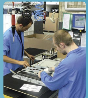
▲ Papan utama diletakkan di atas panel LCD dan dipasangkan dengan sekrup.
