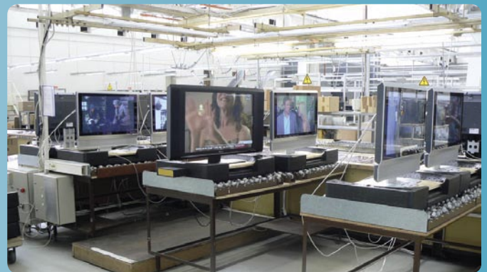
▲ Setelah pemasangan speaker, TV LCD layar datar siap untuk dipasarkan. Beberapa unit contoh dikeluarkan dari jalur produksi dan ditempatkan di sini untuk pengujian jangka panjang.
