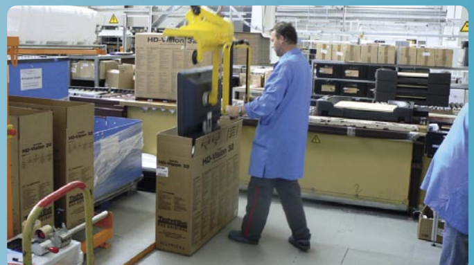
▲ Tahap akhir: alat crane digunakan untuk menurunkan produk akhir dalam kotak pengiriman - dan selesailah sudah!
