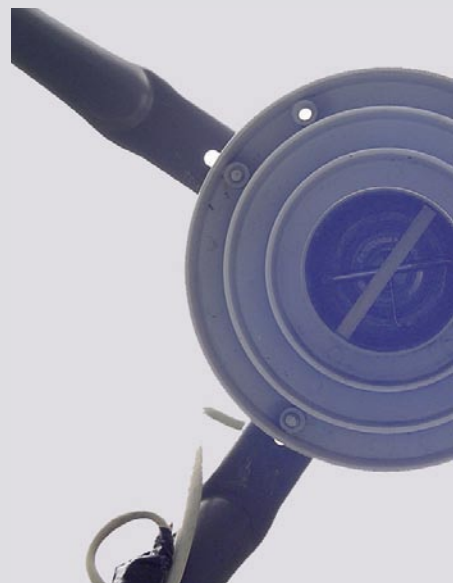
▲ Tampak bagian dalam feed yang terbuka: terlihat jelas dielectric yang diperlukan untuk penerimaan sinyal polarisasi sirkular. Lepaskan jika ingin menerima linear.
