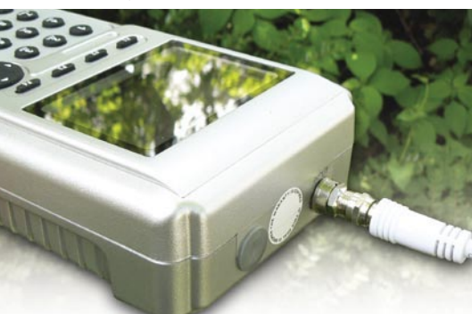
Colokan F untuk menghubungkan LNB terletak di bagian atas.
