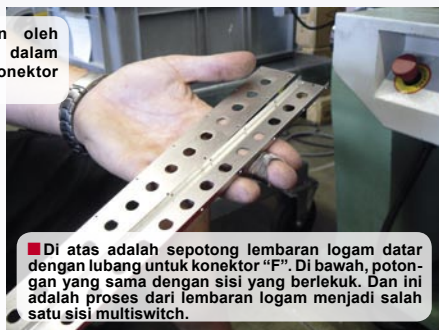
■ Ke mana perginya papan sirkuit tersebut? Ke dalam kotak logam, tentu saja. Dan dari mana asal kotak ini? Dari mesin pemroses ini yang terdapat satu rol lembaran logam dengan lebar 36mm dan tebal 0,7mm serta pelapis nikel 0,02mm. Satu rol baru berbobot 100 kg dan panjang 400 m.
