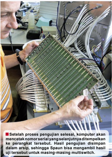
■ Setiap multimeter diuji dengan berbagai fungsi. Multimeter diselipkan ke stasiun pengujian dan dengan memindahkan lever tunggal seluruh konektor „F“ diselipkan dan proses pengujian dapat dimulai.
