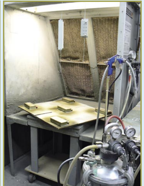
■ MFC melakukan segalanya sendiri: filter yang telah selesai disemprot dengan pelapis pelindung berwarna.
