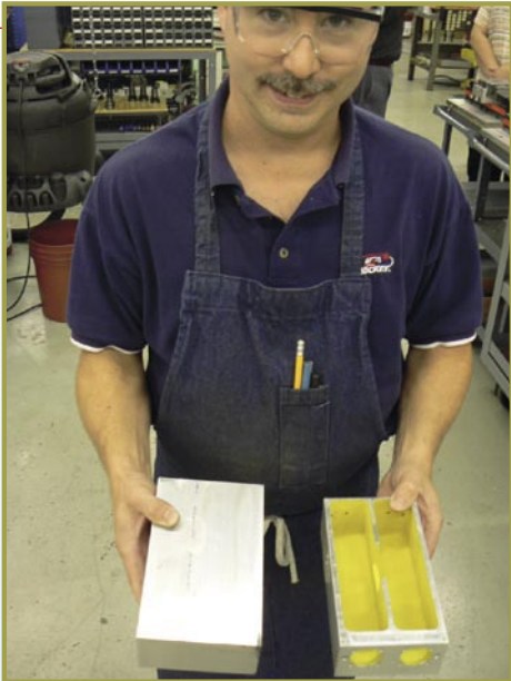
■ Dale Newton menunjukkan tahapan produksi: dari blok padat aluminium (kiri), kotak filter yang lengkap dibor menjadi lubang untuk pemasangan konektor dan sekrup (kanan).
