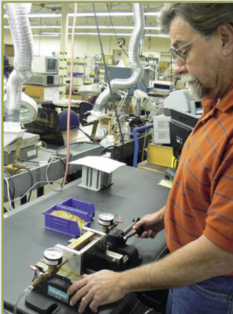
■ Bill Adamo adalah ketua tim Kendali Mutu dan menunjukkan segel filter diuji dengan tekanan: "Filter diletakkan di sini dan ditekan dengan udara pada 5 PSI." Dengan cara ini dapat diperiksa apakah bagian dalam konektor, serta mountingnya kedap udara. "Kebocoran paling kecil bisa menyebabkan kelembaban di dalam dan bisa memengaruhi kinerja filter", kata Bill Adamo, "Kami menguji 100% dari filter kami!" Setiap konsumen dapat dipastikan bahwa seluruh filter MFC mempunyai spesifikasi yang berkualitas tinggi.
