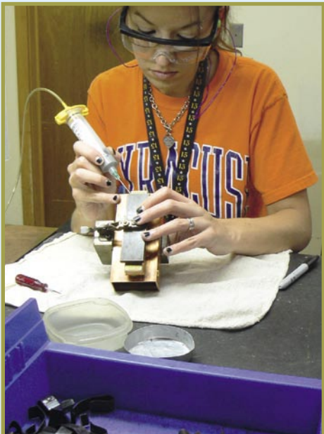
■ Di sini filter dipasang secara mekanis. Karyawan MFC Melissa Bench menyiapkan filter untuk oven solder...
