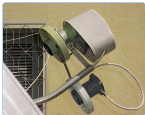
Una varilla de metal es la solución: simplemente conecta el segundo alimento al enfoque con el polarizador integrado
