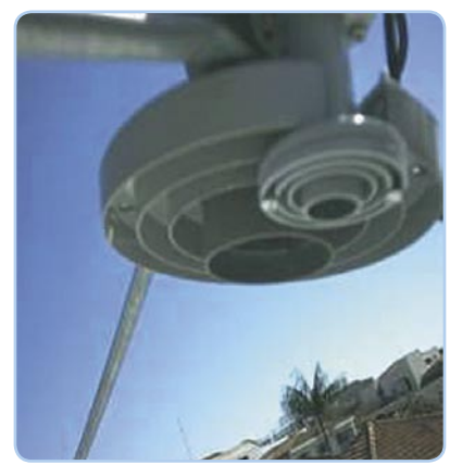
Esto es cómo se logra la recepción simultánea de señales en banda C y Ku. Debido a que la primera antena enfoca un alimento acanallado que se usa para el LNB de banda Ku.
