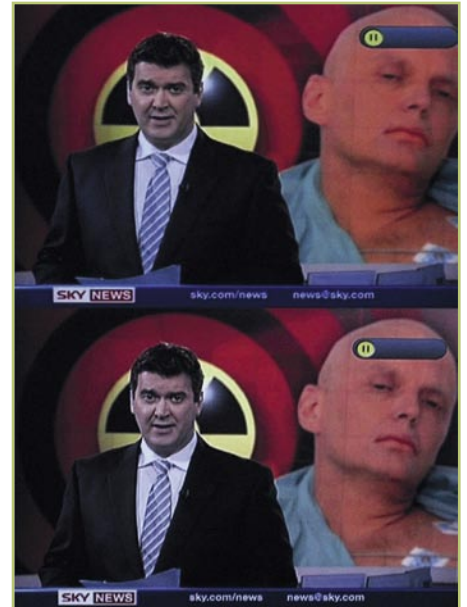
La comparación de la salida de video en una pantalla de LCD que usa una conexión de scart sin scaler (arriba) y HDMI más el scaler (abajo)
