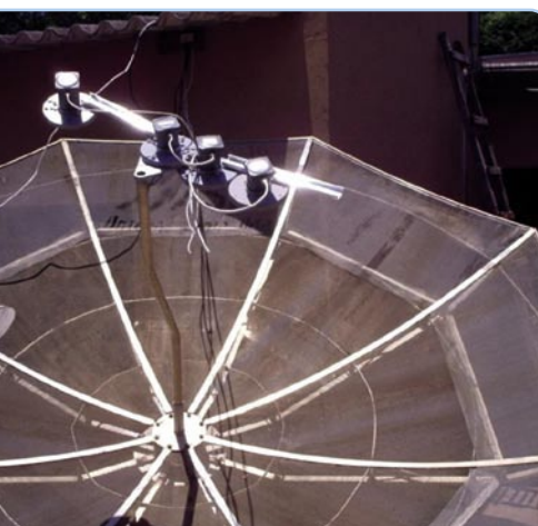
Un rail continuo como la montaje multifeed
