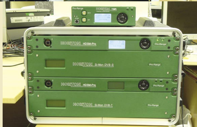
▲ ¡Alto secreto! Las primeras unidades de muestra del ProSeries para las operadoras, por ejemplo para el uso en los camiones de OB para verificar la calidad de la señal. La pequeña unidad pequeña arriba es la TSR Lectora del Flujo de Transporte, también con especificaciones de ProSeries. Las ProSeries se lanzarán en el segundo trimestre del 2008.
