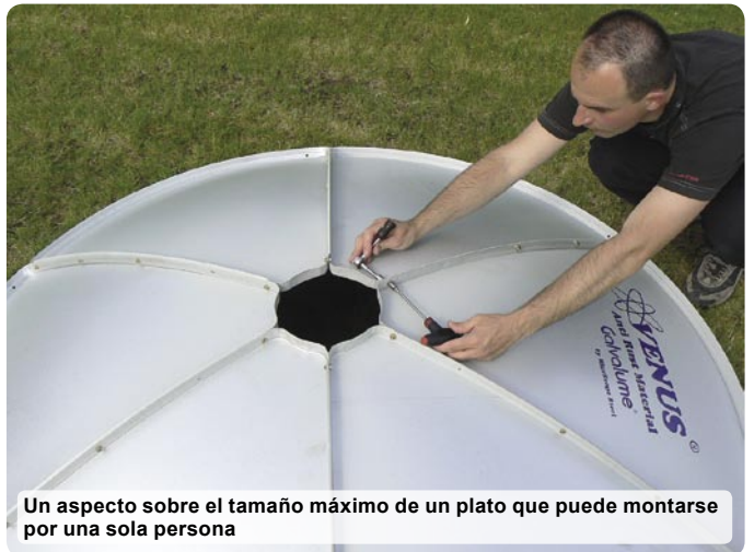
Los laterales de los segmentos son en parte abovedados aumentar la estabilidad
