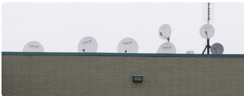
Les paraboles satellite sont sur le toit de Fortec Star et sont à peine visibles. Les deux paraboles à gauche sont des modèles de 90 cm, dont l'une est opérée par un moteur STAB HH90 et l'autre avec un moteur STAB HH120.
