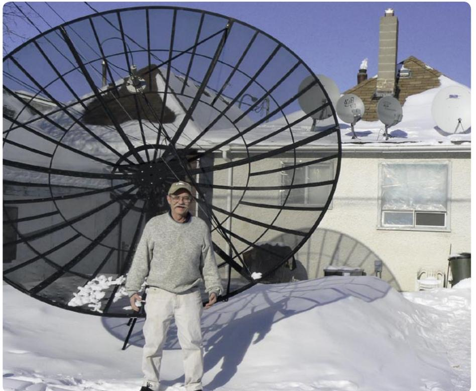
Avec ses 60 ans, Jerry ne fait que commencer. On le voit ici dans sa cour devant sa parabole de 3,6 mètres. L'année dernière il a remplacé la surface ajourée de cette parabole. Il y a installé un assemblage de source/LNB pour les bandes C/ Ku accompagnés d'un vérin de la marque américaine Von Weissen St. Louis. Ses satellites préférés sont SatMex 5, G3, AMC1 et Galaxy 4. Il utilise la parabole de 100 cm avec moteur qui est placée
