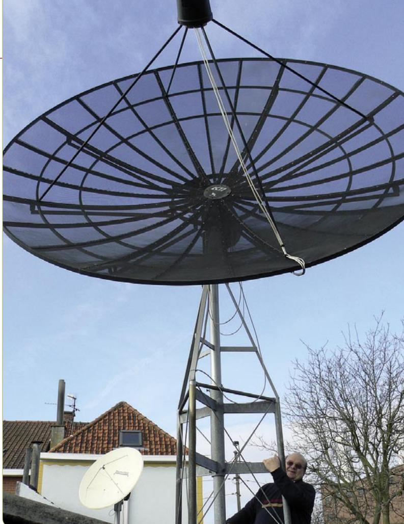
L'antenne d'Aimé est tellement grande qu'on n'arrive presque pas à placer le LNB (en haut) et la tête d'Aimé (en bas) sur une même photo. Sur le côté gauche, en arrière plan vous pouvez apercevoir une autre parabole motorisée de 1,8 mètres pour la bande Ku.
