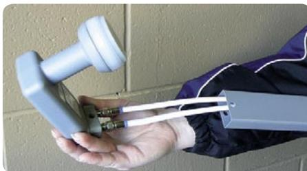
Voici un LNB avec un support de type « D ». Ici en Amérique du Nord, les câbles coaxiaux des LNB sont généralement enfilés dans le bras support. Pour réaliser ceci on dispose de deux supports différents : Les rectangulaires et les « D ». L'utilisation d'un LNB avec un bras support approprié ou même un support multi sources protège les connexions des intempéries.
