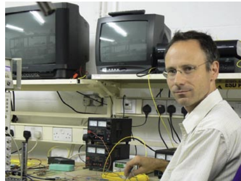
Mike vérifie les prototypes. Ici nous voyons un échantillon : Un signal satellite produit artificiellement est envoyé à travers un câble à fibres optiques d'une longueur de 30-mètres vers un convertisseur. Il utilise une sonde pour déterminer si les signaux originaux arrivent aux analyseurs dans les marges de tolérance.
