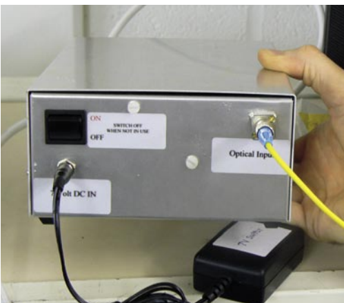
Et voici à quoi ressemble le prototype de boîtier mural : l'entrée fibre optique est sur le devant tandis que le raccordement standard pour un câble coaxial de récepteur est sur le dos. Comme vous pouvez voir, le boîtier mural a besoin d'être alimenté. Dans l'utilisation actuelle, plus tard, le boîtier mural recevra son alimentation de l'entrée LNB du récepteur satellite.
