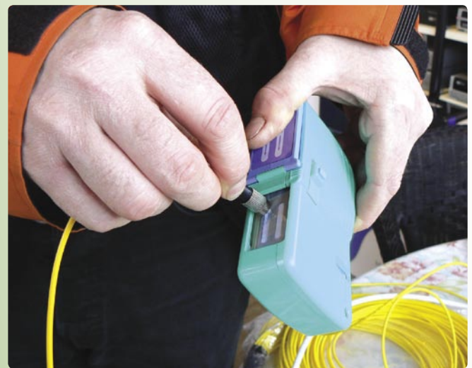
Un mot de précaution à tous les installateurs : Ne jamais brancher simplement les câbles à fibres optiques - les raccordements des câbles doivent être parfaitement propres avant qu'ils soient remontés. Diverses méthodes peuvent être employées pour réaliser ceci ; la plus pratique est d'employer le dispositif montré ici : le connecteur d'un câble à fibres optiques est inséré et un levier est alors actionné pour nettoyer le connecteur avec un papier émeri à grain extrêmement fin - et qui est utilisé seulement une fois. C'est la seule manière de garantir qu'un raccordement branché est établi sans aucune atténuation de signal.
