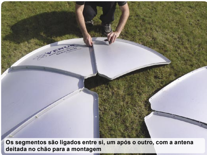
O início da montagem com o editor de ensaios Sylvain Oscul da TELE-satélite com dois segmentos
