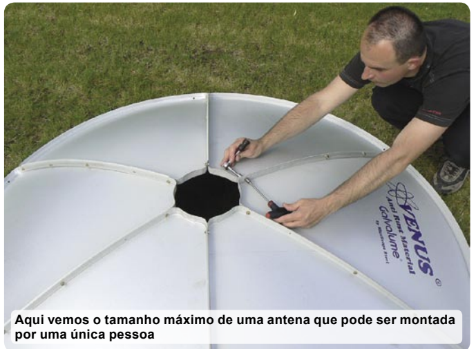
Os flancos dos segmentos têm esta forma para aumentar a estabilidade
