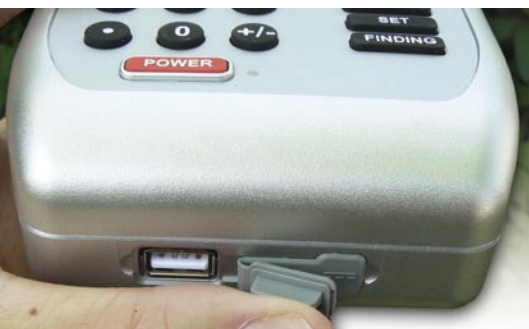
Interface USB para conectar o dispositivo ao PC, ao lado do soquete de alimentação de energia.
