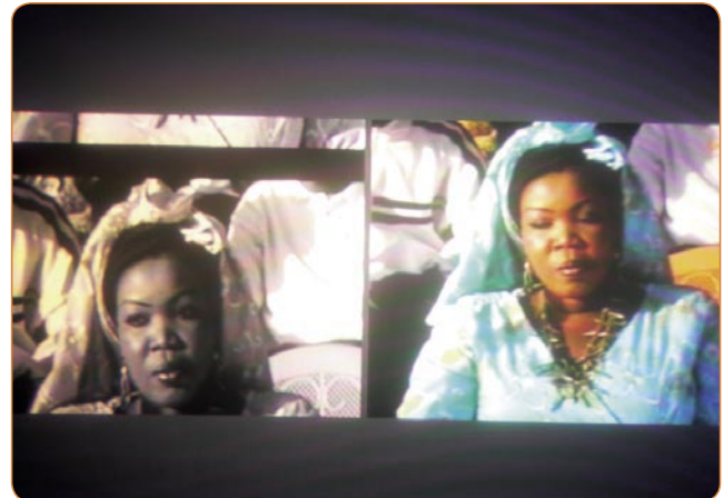
Tony, Sony marka televizyonunun video girişini bölerek iki alıcıyı aynı anda test edebiliyor. Yukarıdaki görüntüde, sol tarafta Quali HD alıcısından aldığı PAL sinyali görüyoruz. Sağ tarafta ise aynı kanalın LNB spliteri ile Fortec Star alıcısından gelen görüntüsü. Bu yöntemle PAL sinyallerin NTSC'ye doğru bir şekilde dönüştürülmediğini kontrol ediyor.
