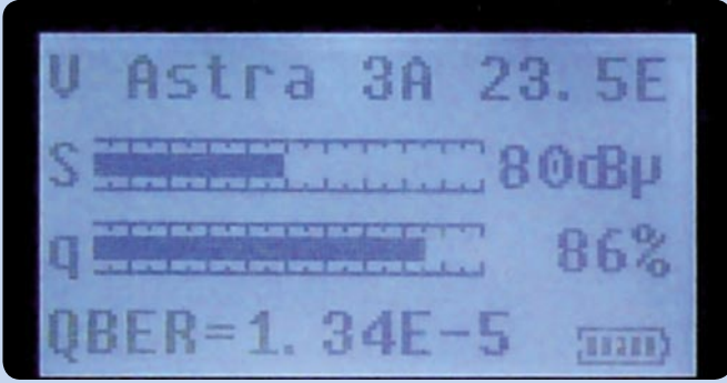
Düzeltilmeden önceki Sinyal Seviyesi ve Kanal BER değeri
